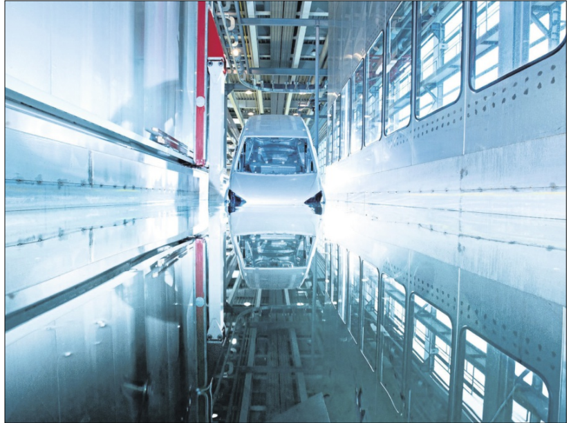
TIEFGANG: Mikroorganismen wie Bakterien fühlen sich in den Lackieranlagen der Automobilbranche wohl. Um sie zu bekämpfen, werden bislang häufig Biozide eingesetzt. Elektroimpulse sollen die chemischen Zusätze künftig verdrängen. Foto: dpa
