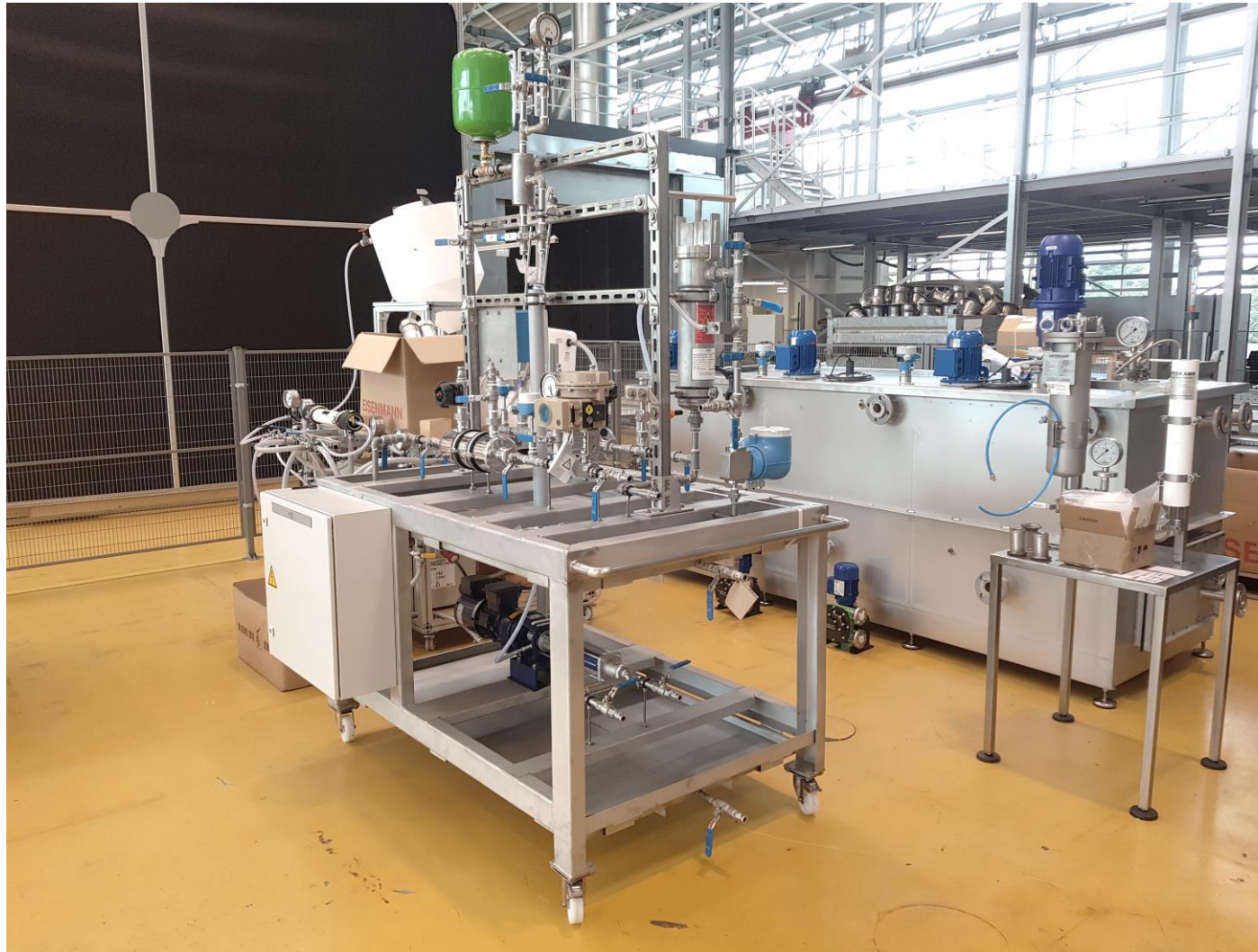
Betriebsbereite Beckenkaskade im Technikum bei Eisenmann
