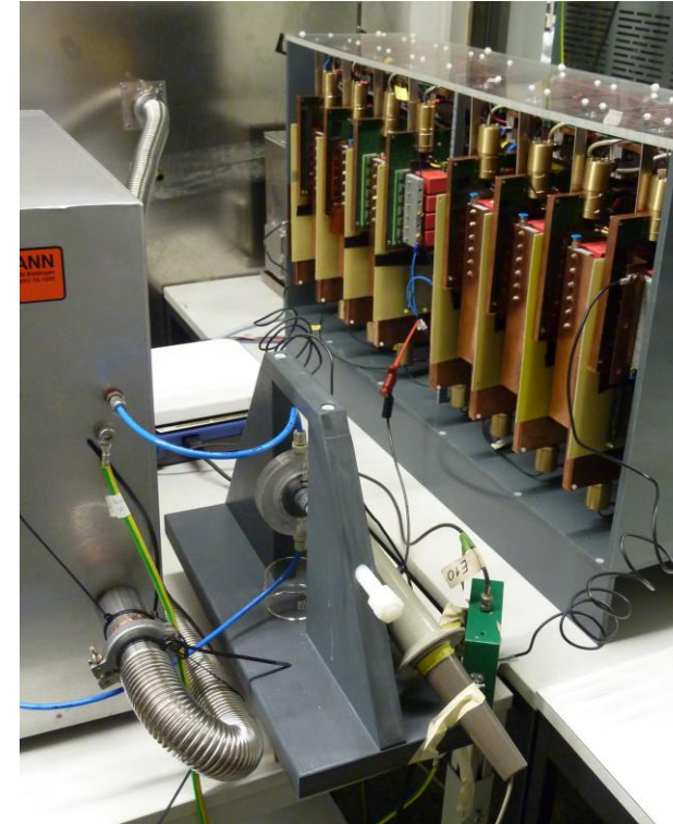
Generator und Behandlungszelle
